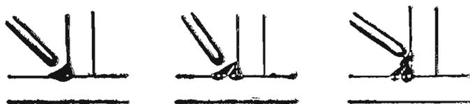
Tre fasi di una saldatura tenera, con lega di piombo e stagno
