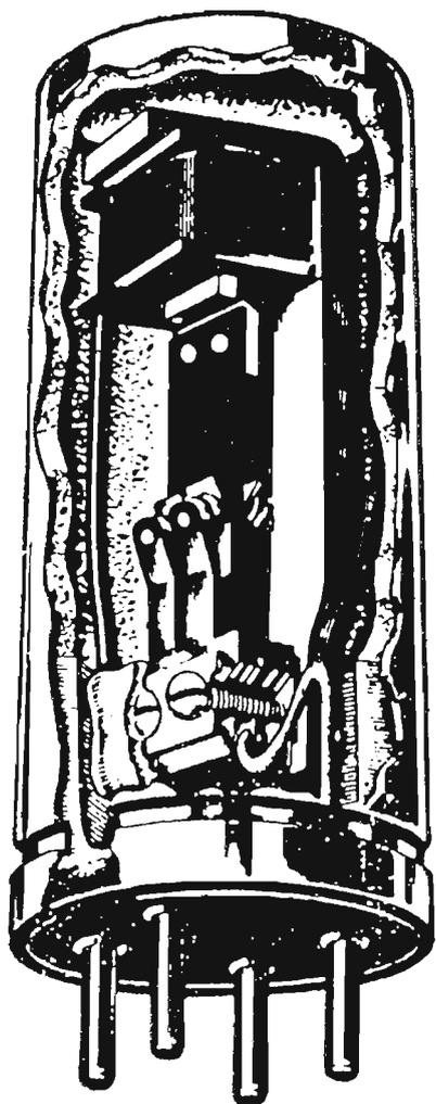
Sezione di un vibratore
